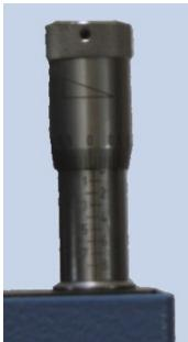
❖ El micrómetro permite un ajuste fácil del diámetro
